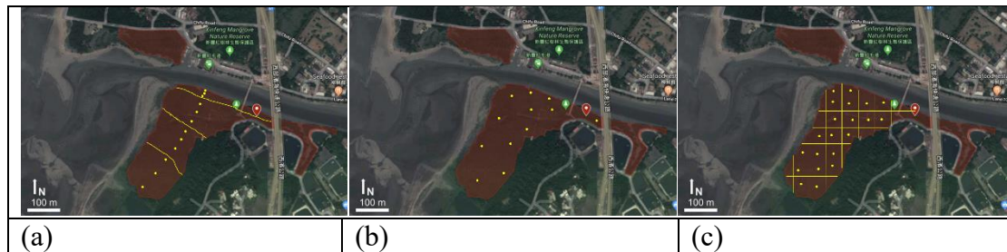
圖1、測站排列策略 (a) 線性設計 (b) 隨機設計 (c) 網格設計
