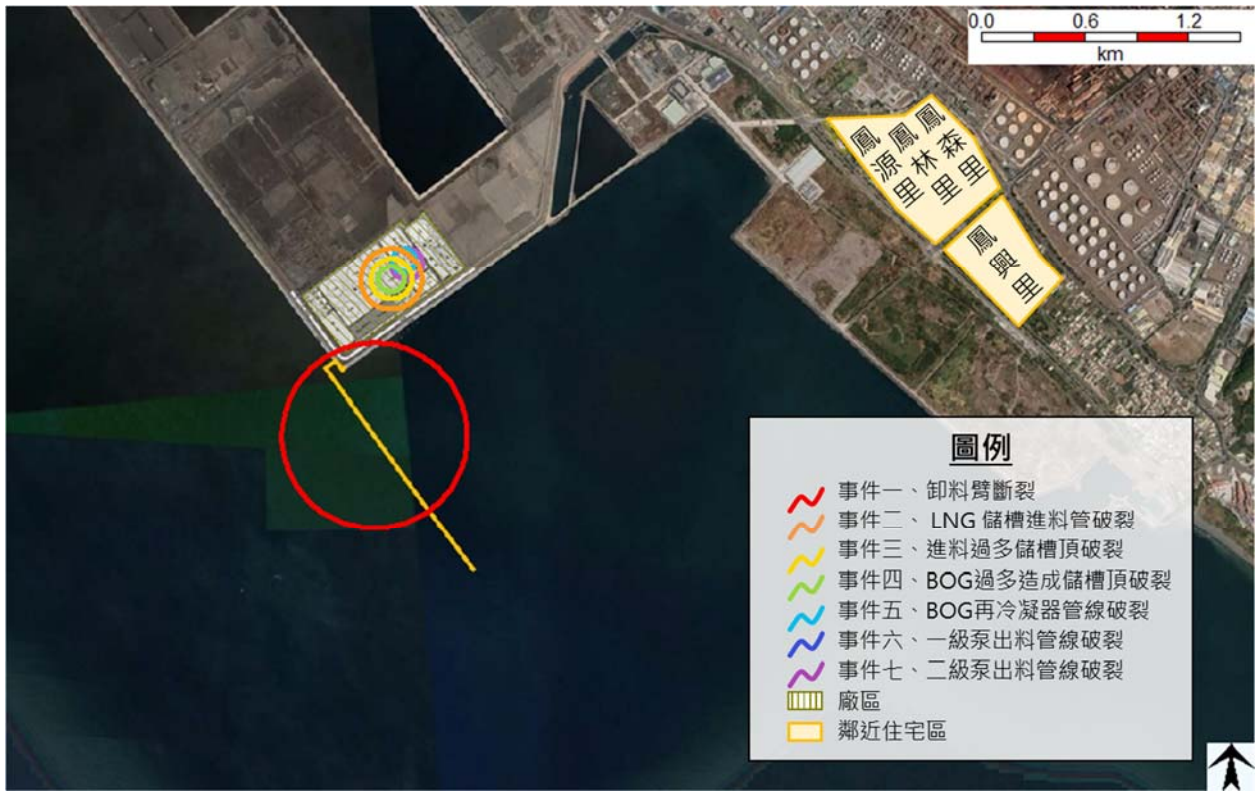
圖 7.13-3 各事件於實施減輕措施前之熱輻射 4 kw/m 2 影響範圍 (風速 7.7 m/s，大氣穩定度 D)
