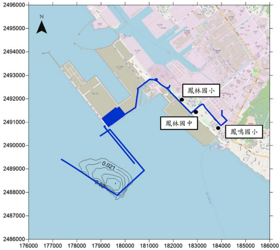
圖 7.3-9 施工期間 NMHC 之小時值增量模擬圖
