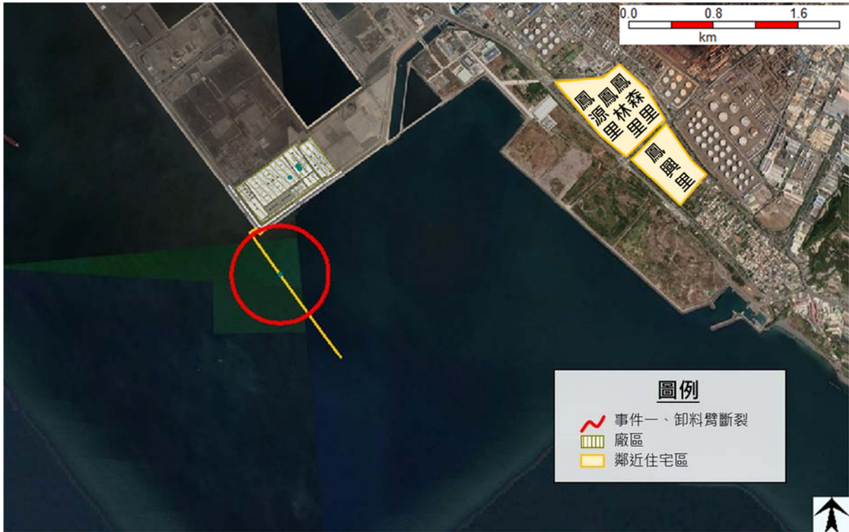
圖 7.13-1 實施減輕措施前之擴散濃度 50,000 ppm 地面影響範圍 (風速 7.7 M/S，大氣穩定度 D)
