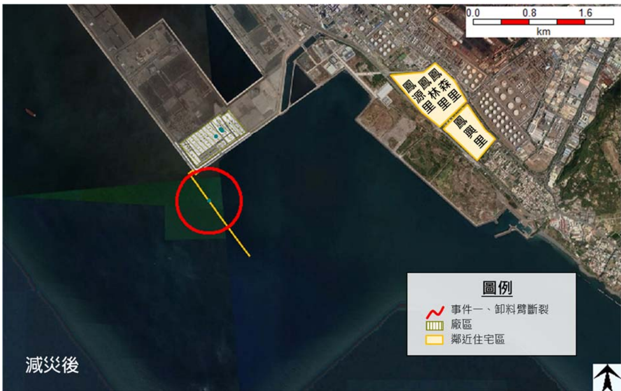
圖 7.13-2 實施減輕措施後之擴散濃度 50,000 ppm 地面影響範圍 (風速 7.7 M/S，大氣穩定度 D)
