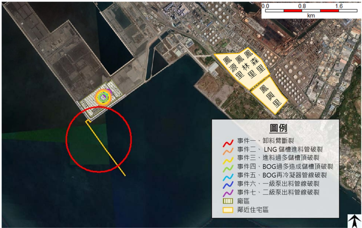
圖 7.13-5 各事件於實施減輕措施前之爆炸超壓 0.14 barg 影響範圍 (風速 7.7 m/s，大氣穩定度 D)
